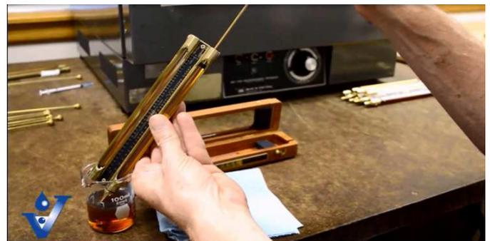
**Figuras 3/4 - Flushing e enchimento do "visgage"**
