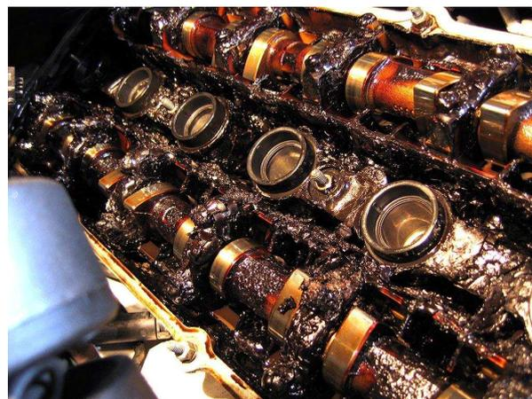
**Figuras 10/11 - Espessamento do óleo lubrificante de cárter**
