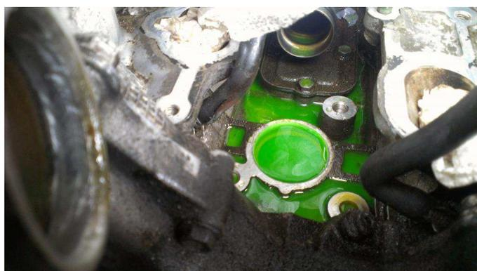
**Figuras 12/13 - Monitoramento de contaminação do óleo lubrificante de cárter por líquido de sistema de arrefecimento**
