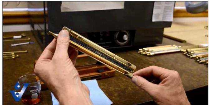
**Figuras 5/6 - Ajustes das esferas metálicas no ponto zero das escalas do tubo referência e tubo amostra**
